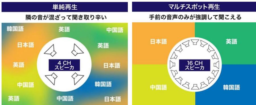
複数のスピーカを用いて各スピーカが発する音同士を相互干渉させるのが基本的な仕組みです。
